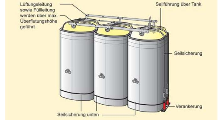
**Batterietanksysteme**, die speziell gesichert und für die Aufstellung in überschwemmungsgefährdeten Gebieten zugelassen sind, bieten optimale Raumnutzung und eine hohe Flexibilität bei der Heizöllagerung.
